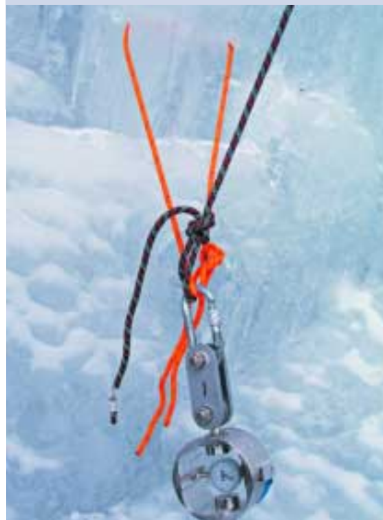
Abb. 5: Gebohrte Eissanduhren gelten als solide Fixpunkte
