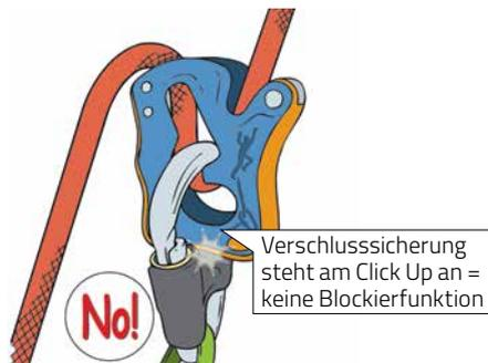
Abb. 3: Bei Sicherungsgeräten Hersteller-Empfehlungen beachten, damit's funktioniert.
